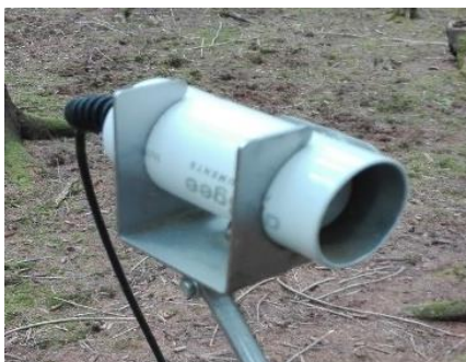
Obrázek 9 Detail infračerveného teploměru (Autor: Kalina Ondřej).
