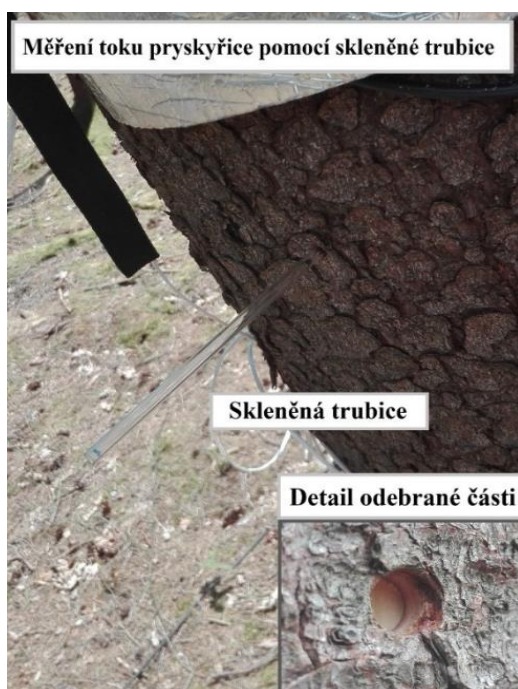
Obrázek 10 Měření toku pryskyřice pomocí skleněné trubice a detail díry po odběru puku (Autor: Stříbrská Barbora).
