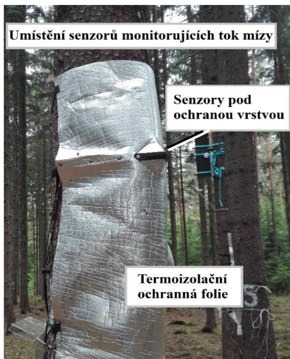
Obrázek 8 Umístění senzorů monitorujících tok mízy, zakrytých ochranou termoizolační vrstvou (Autor: Kalina Ondřej).
