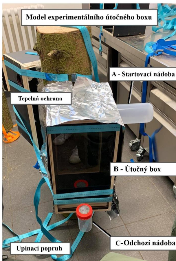
Obrázek 5 Útočný experimentální box s možnostmi volby pohybu: setrvání ve startovací nádobě, možnost pohybu do boxu a po něm, přístup ke kůře stromu a možnost úniku do odchozí nádoby. A – Startovací nádoba, B – Útočný box, C – Odchozí nádoba, (Autor: Stříbrská Barbora).
