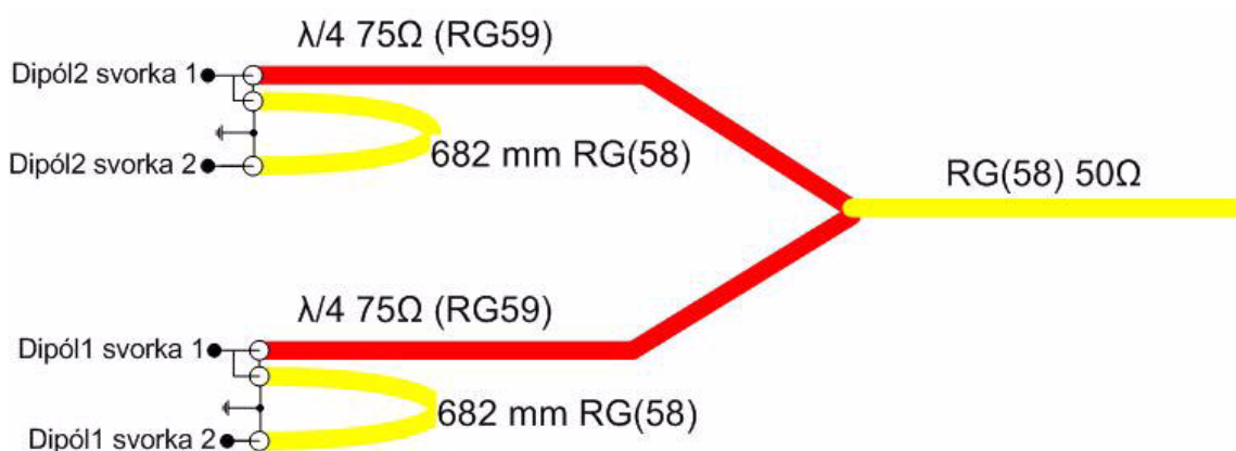
Obr. 5.1 Elektrické zapojenie krížovej Yagiho antény pre frekvenciu 145 MHz
