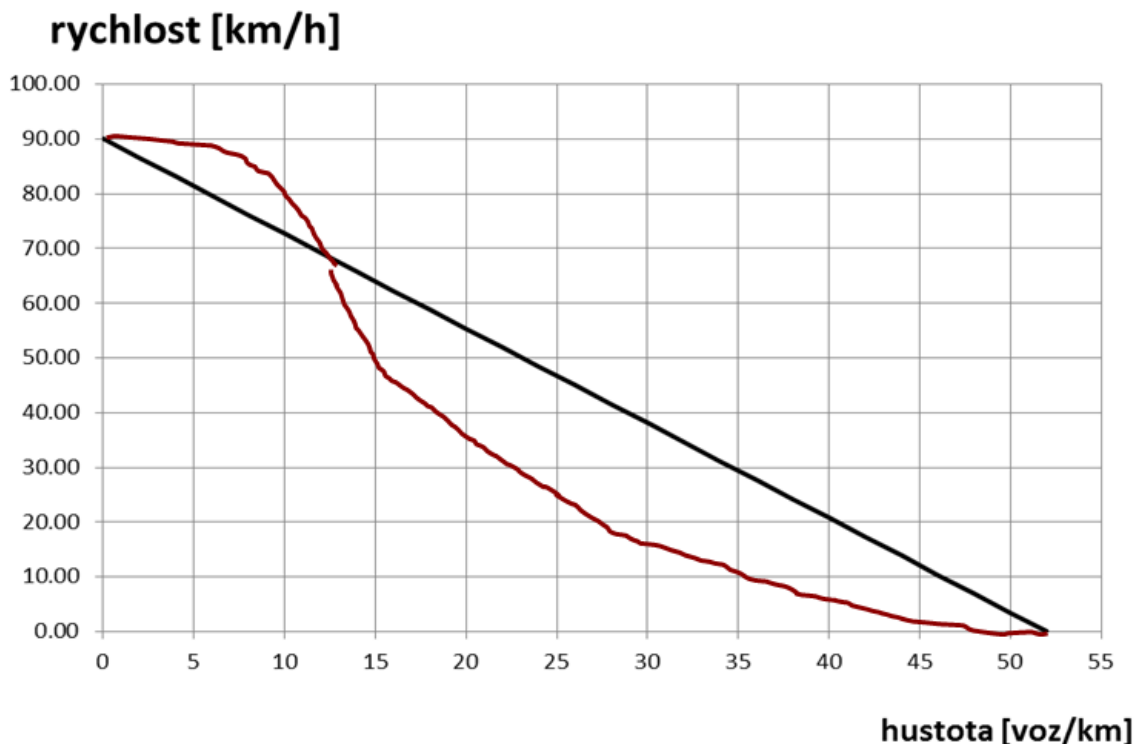
Obrázek 33: Obecný fundamentální diagram (závislost hustoty na rychlosti) [34]
