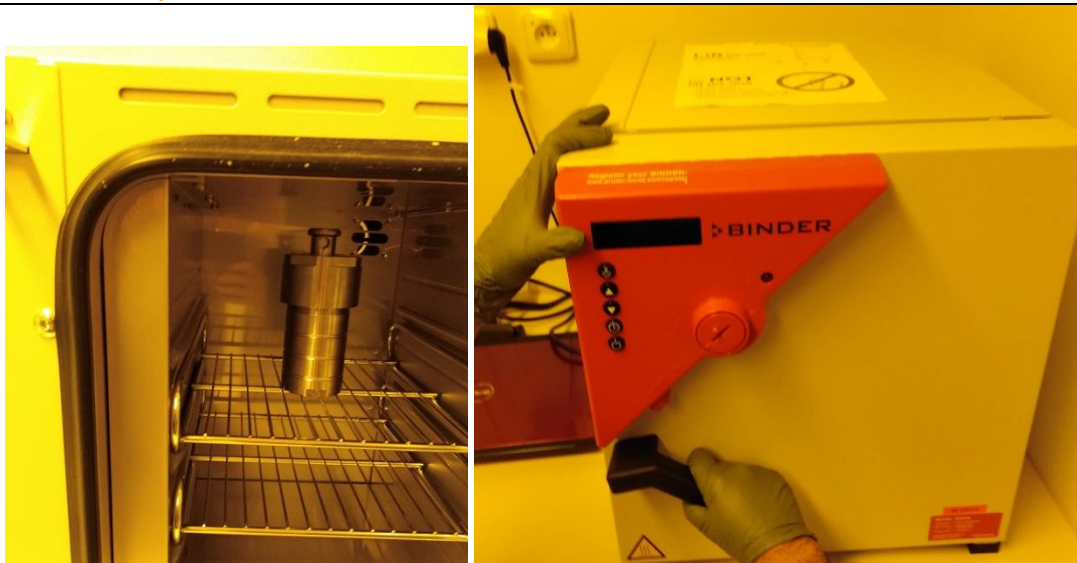
Obr. 30,31: (vlevo) Vložený autokláv v peci, (vpravo) uzavření elektrické pece Binder ED 23. Zdroj: Vlastní
