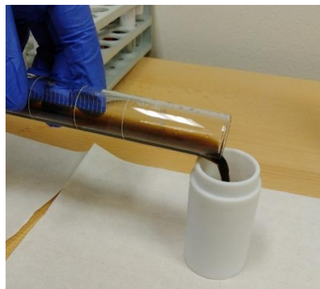
Obr. 28,29: (vlevo) Rozložený autokláv, (vpravo) přelívání suspenze oxid grafenu do silikonového jádra autoklávu. Zdroj: Vlastní
