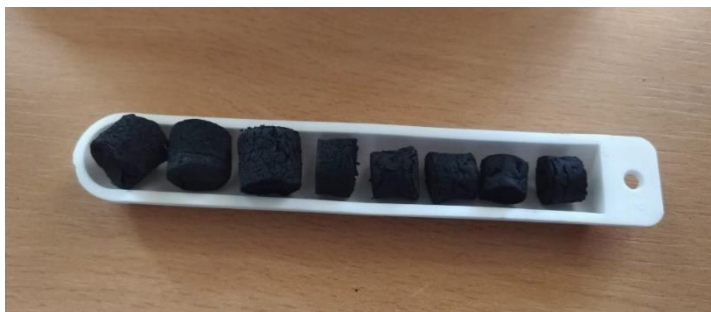
Obr. 35: Umístění vzorků na keramické podložce. Zdroj: Vlastní
