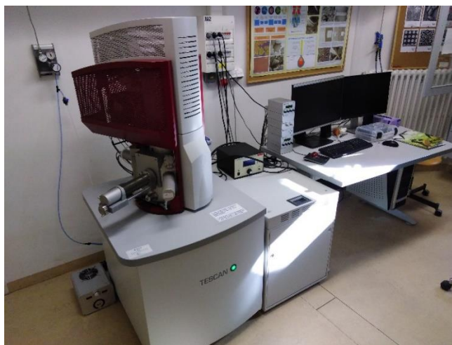
Obr. 53: Laboratoř mikroskopie se skenovacím elektronovým mikroskopem Tesca MAIA3. Zdroj: Vlastní
