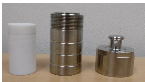
Obr. 28,29: (vlevo) Rozložený autokláv, (vpravo) přelívání suspenze oxid grafenu do silikonového jádra autoklávu. Zdroj: Vlastní
