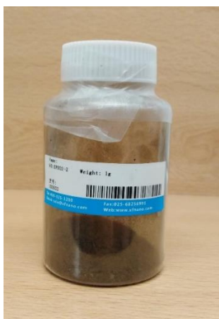
Obr. 24,25: (vlevo) prášek oxid grafenu – XF002-2, (vpravo) laboratorní váha Sartorius M-pact AX224 Zdroj: Vlastní
