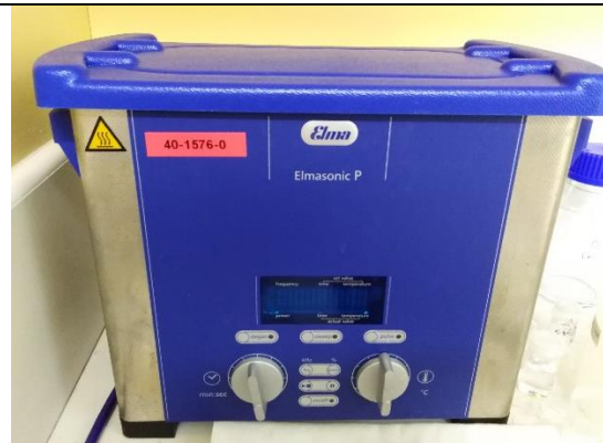
Obr. 27: Ultrazvukový čistič – Elmasonic P. Zdroj: Vlastní
