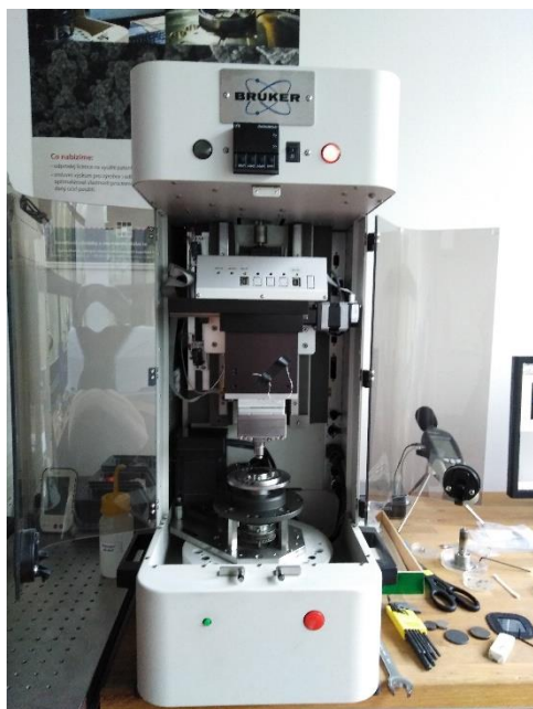
Obr. 46,47: (vlevo) měřicí přístroj tribometr – UMT-3MT-230, (vpravo) úprava měřicího zařízení. Zdroj: Vlastní
