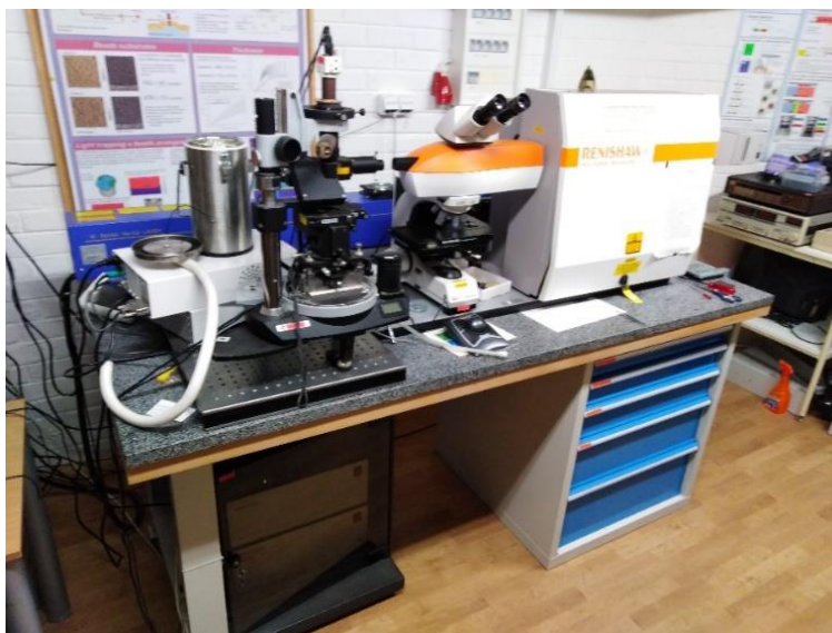
Obr. 37: Měřicí soustava Ramanovy spektroskopie. Zdroj: Vlastní
