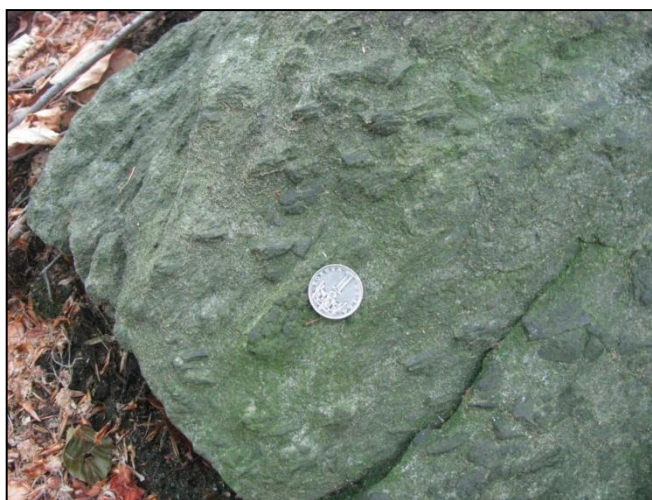
Obr. 8. Blok v deluviu (SV-5), 70 x 120 cm, staurolitický svor s biotitem a porfyroblasty staurolitu o velikosti až 22 mm.
