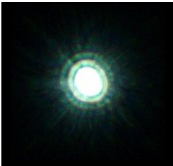
Obrázek 13: Detekovaný Airyho disk na čočce f/25 [25]
