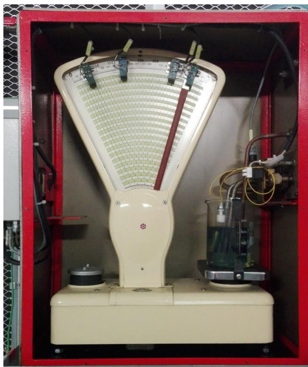
Obr. 34 Automatizované měření spotřeby paliva pomocí váhy
