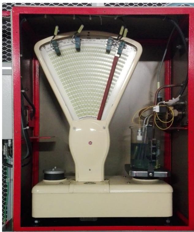
Obr. 34 Automatizované měření spotřeby paliva pomocí váhy
