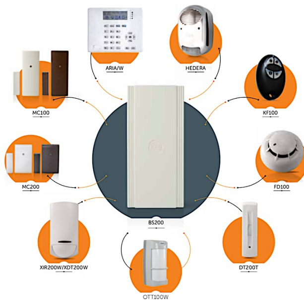
Obrázek 39: Princip zapojení bezdrátových komponentů [zdroj: vlastní]
