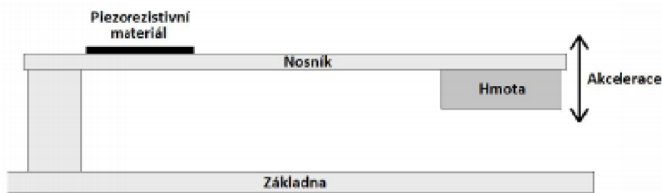
Obrázek 2.11: Princip piezorezistivního akcelerometru
