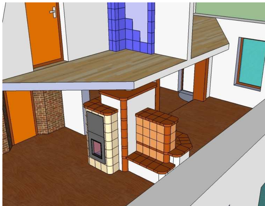
Obrázek B 39 - Umístění kamen vzhledem k využití hypokaust systému
