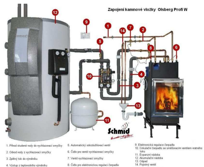
Obrázek A 3 - Připojení kamnové teplovodní vložky k akumulační nádobě (9)
