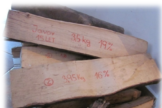
Obrázek C 11 - Příprava paliva na zátop - určení druhu, hmotnosti a vlhkosti jednotlivých polen
