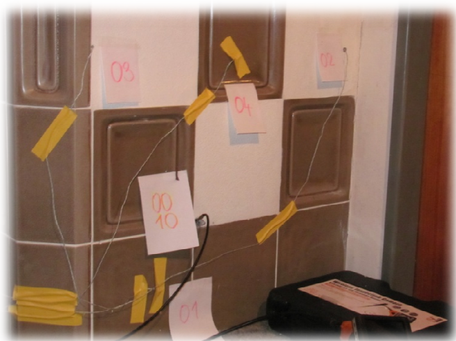
Obrázek C 13 - Umístění a popis čidel v horních hypokaustových kamnech
