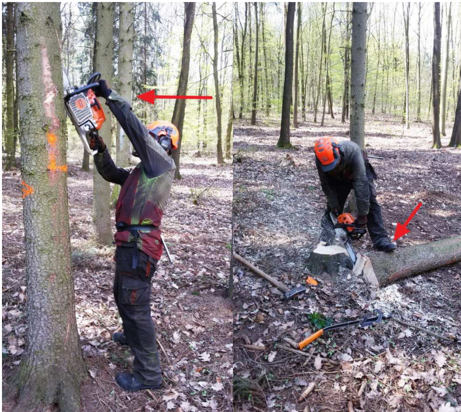
Obr. 5 Používání zakázaných způsobů práce při těžbě dříví (Mánek, 2016)
