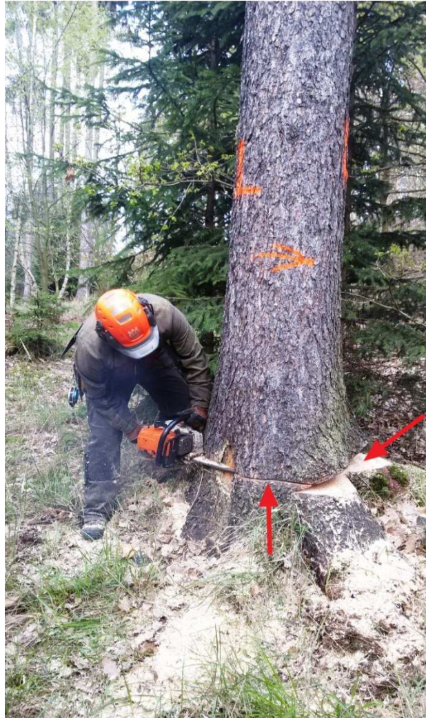
Obr. 4 Nedodržení parametrů pařezových prvků (Mánek, 2016)
