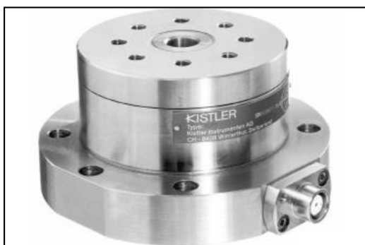
Obr. 3 Dynamometr KISTLER pro měření složek řezných sil při vrtání [14]
