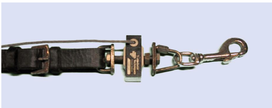
Obr. č. 14: Tenzometr MLP-300, Transducer Technologies, váha 85 g, měřitelný rozsah 1334 N (Clayton et al. 2005).
