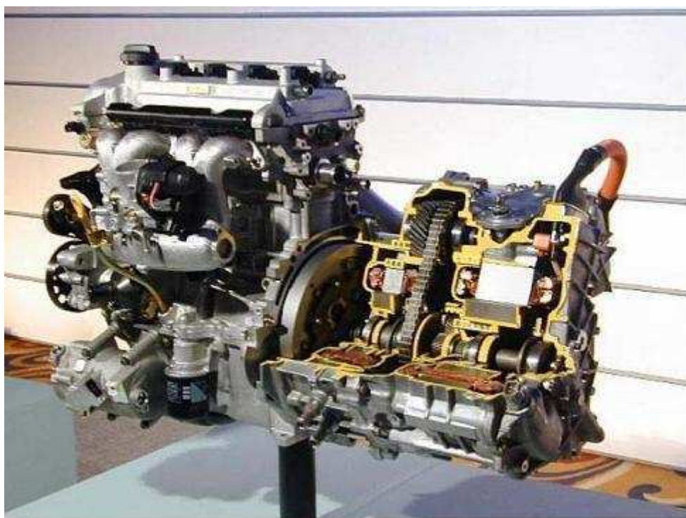
Obr. 4.9 – řez převodovou skříní Toyota Prius II [25]
