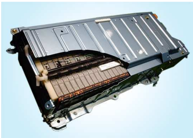
Obr. 4.5 – Ni-MH akumulátor Toyota Prius II [22]
