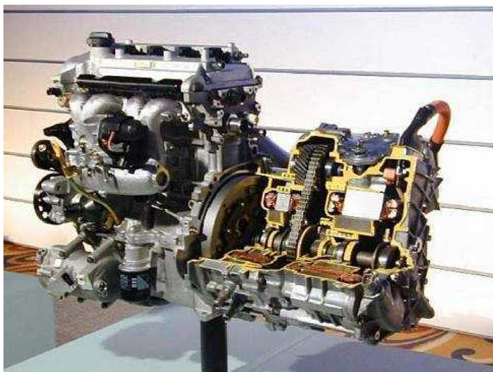
Obr. 4.9 – řez převodovou skříní Toyota Prius II [25]
