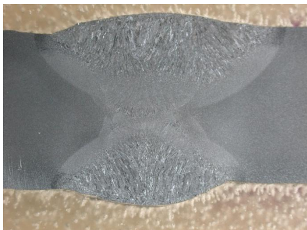
Obr. 3-17 Metalografický výbrus desky 2-0-0
