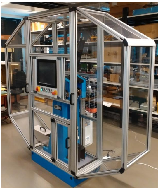
Obr. 3-28 Rázové kladivo LabTest CHK 450J
