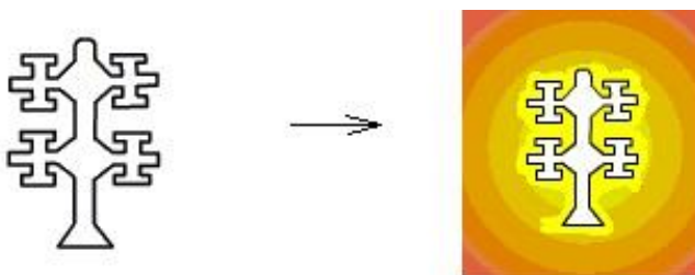
Obr. 1.8 Vytvrdzovanie škrupiny žihamím [1].
