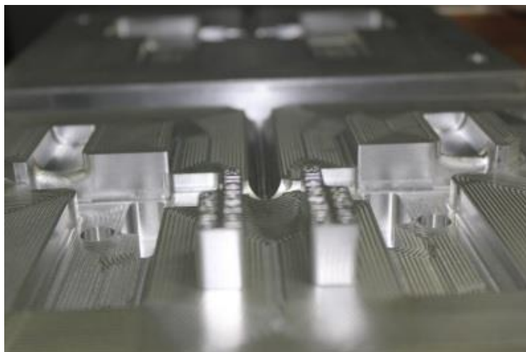
Obr. 1.14 Forma na voskové modely.
