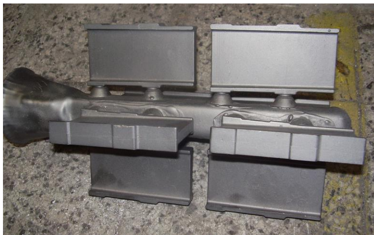
Obr. 2.20 Odliate súčiastky po dokončovacom čistení.
