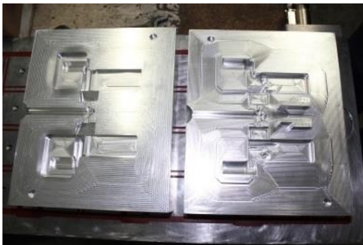
Obr. 1.13 Forma na voskové modely
