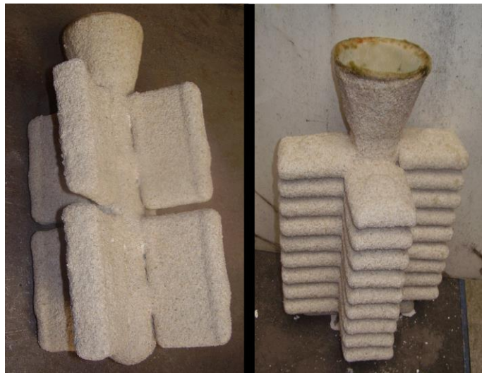
Obr. 2.18 Hotové škrupiny formy pripravené na odlievanie.
