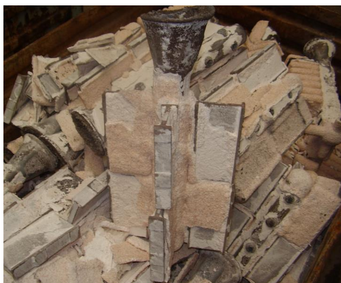
Obr. 2.19 Čistenie odliatkov od škrupín.
