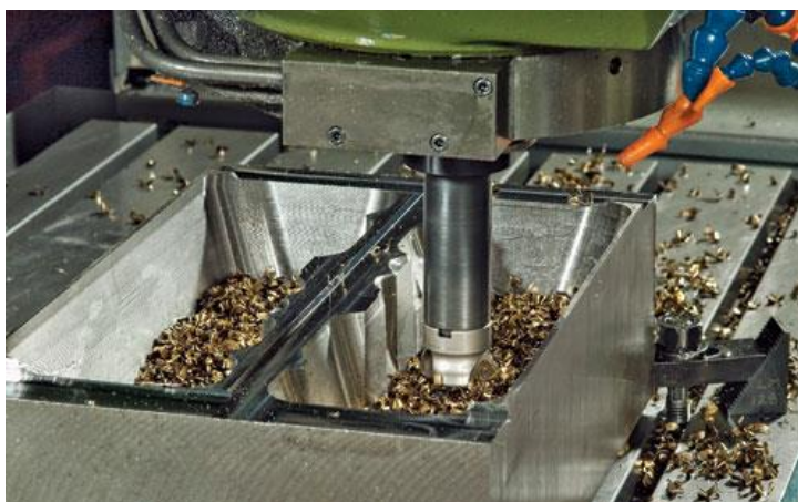
Obr. 1.15 Trieskové obrábanie formy na CNC frézke [9].
