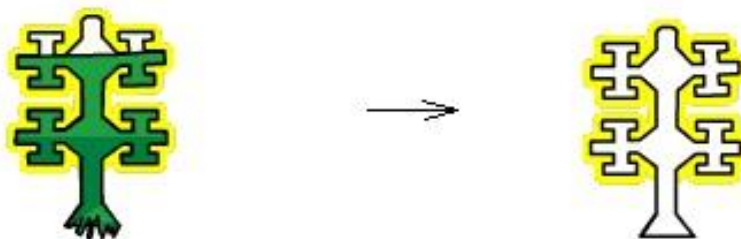
Obr. 1.7 Odstraňovanie vosku z dutín vytavovaním [1].
