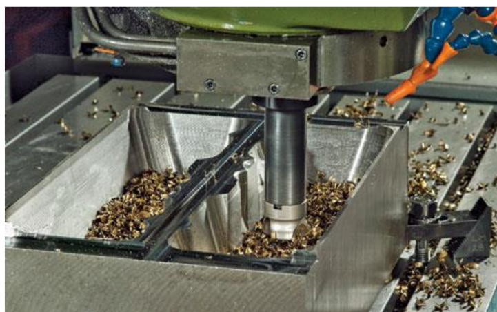
Obr. 1.15 Trieskové obrábanie formy na CNC frézke [9].
