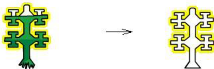
Obr. 1.7 Odstraňovanie vosku z dutín vytavovaním [1].
