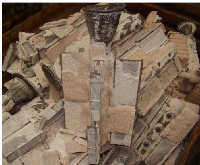
Obr. 2.19 Čistenie odliatkov od škrupín.
