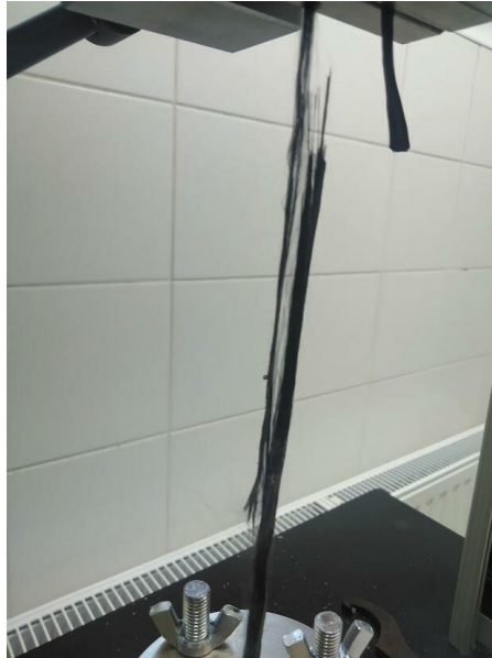
Obrázek 24: Neostrý přetrh testovaného svazku vláken
