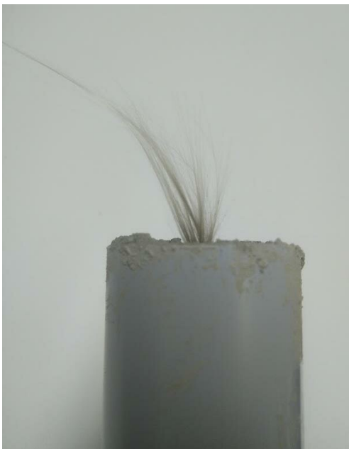
Obrázek 26: Přerušení na hranici matrice a vnějšího prostředí
