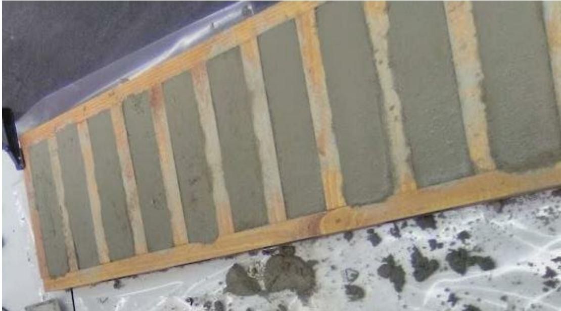
Obrázek 19: Obrázek formy bednění
