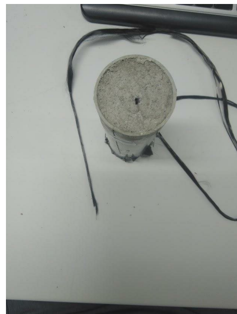
Obrázek 25: Vytažený svazek vláken z matrice
