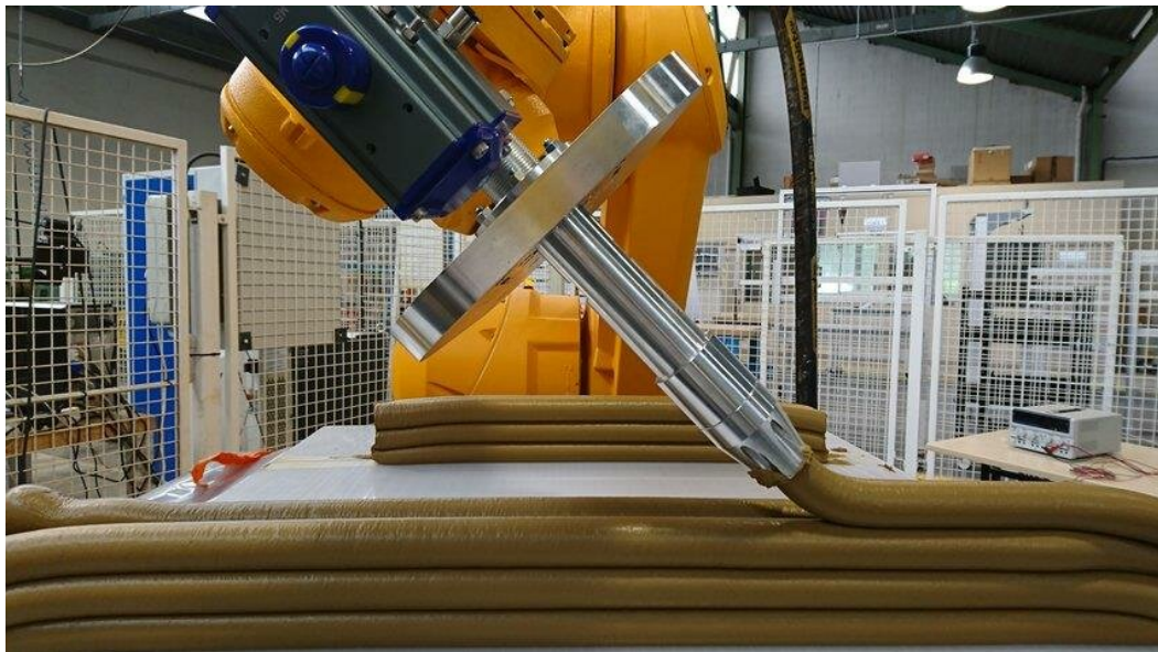
Obrázek 4: Vytlačovací hlava skládající vrstvy materiálu na sebe [10]
