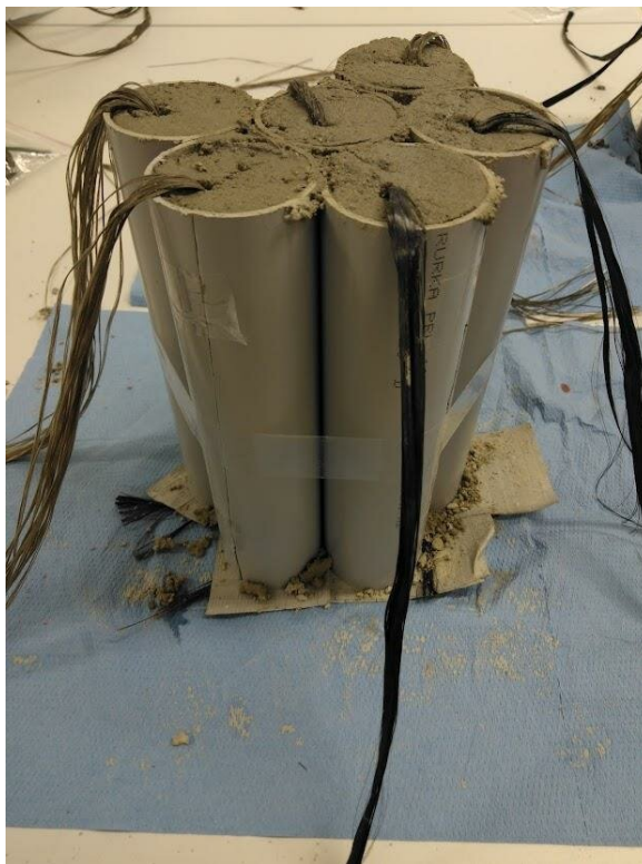
Obrázek 22: Výrobek těsně po odlití betonu
