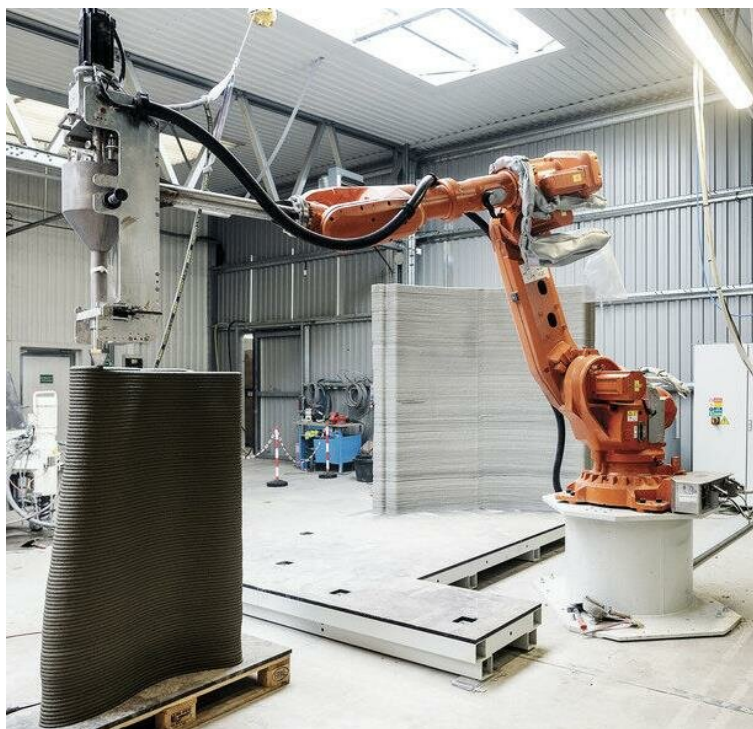
Obrázek 7: Příklad šestiosého robotického ramene [13]
