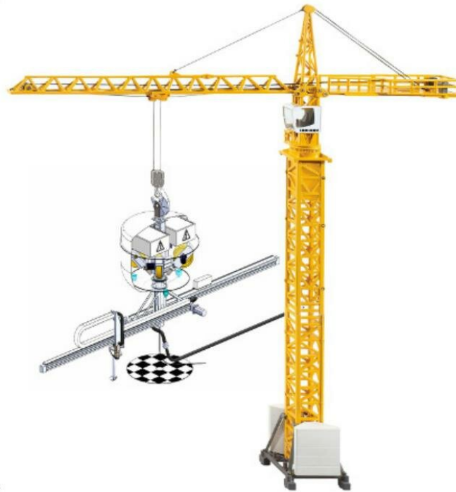
Obrázek 10: Jeřáb nesoucí tiskovou hlavu s gyroskopem [11]
