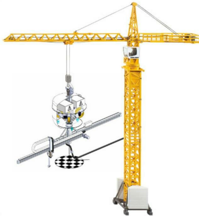
Obrázek 10: Jeřáb nesoucí tiskovou hlavu s gyroskopem [11]
