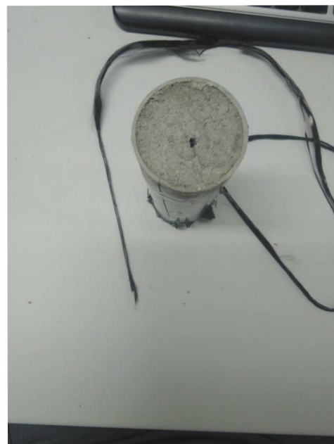
Obrázek 25: Vytažený svazek vláken z matrice
