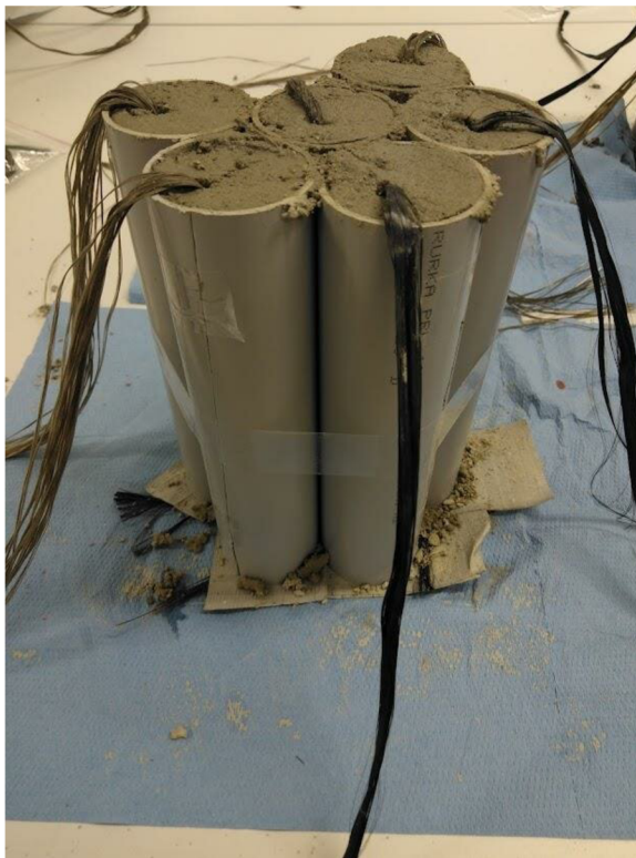
Obrázek 22: Výrobek těsně po odlití betonu
