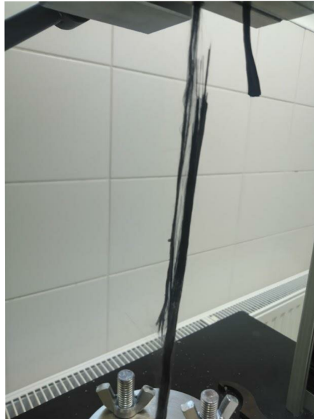
Obrázek 24: Neostrý přetrh testovaného svazku vláken
