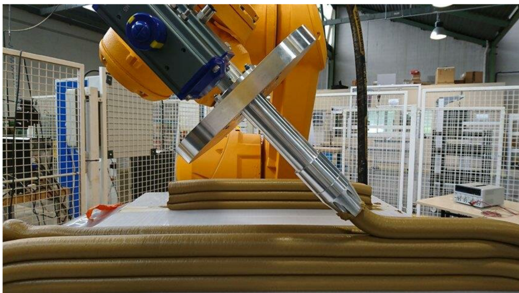
Obrázek 4: Vytlačovací hlava skládající vrstvy materiálu na sebe [10]
