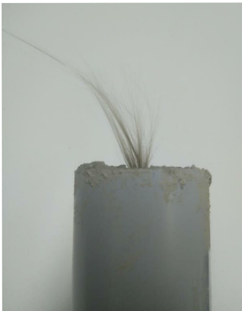
Obrázek 26: Přerušení na hranici matrice a vnějšího prostředí
