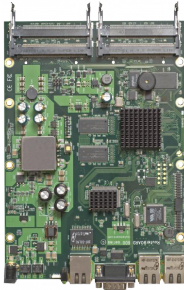
Obrázek 6: RB600A 128 MB RAM, 400 MHz, 4x miniPCI, 3x LAN, vč. L4 [10]
