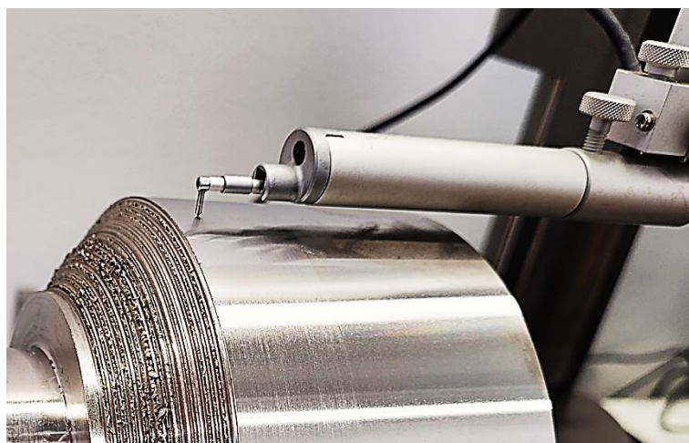
Obr. 34 Detail diamantového hrotu se snímaným povrchem
