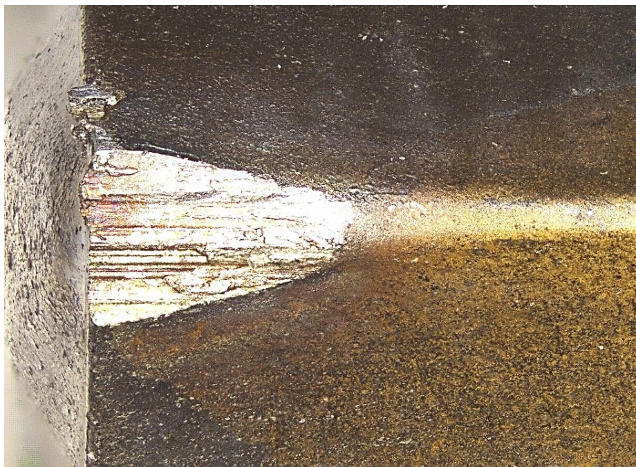
Obr. 39 Pohled na lom CVD destičky ze špičky nástroje po 40 minutách při v_c = 300 \text{ m} \cdot \text{min}^{-1}
