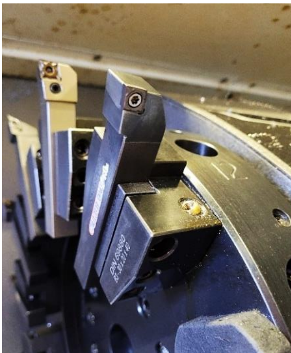
Obr. 22 Upnutí soustružnického nože v revolverové hlavě
