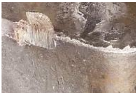
Obr. 6 Nárůstek na hřbetu [27]
