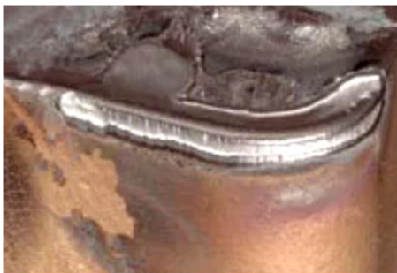
Obr. 3 Opotřebení na hřbetu [27]
