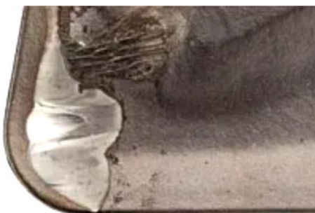
Obr. 4 Opotřebení ve tvaru žlábků [27]
