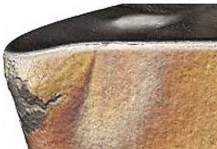
Obr. 7 Plastická deformace břitu [27]
