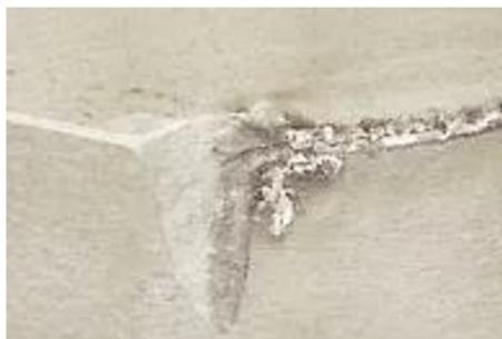
Obr. 5 Opotřebení ve tvaru vrubu [27]
