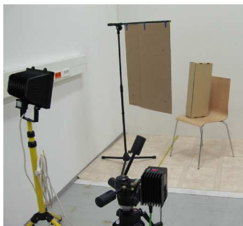
Obr. 8.18: Scéna 5: Vliv osvětlení na přesnost senzoru
