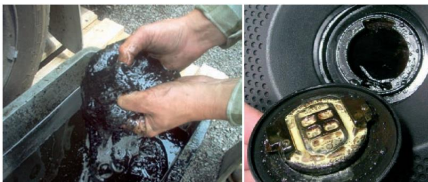
Obr. 2-14 Degradace motorového oleje glykolem a jeho přítomnost v oleji [26]
