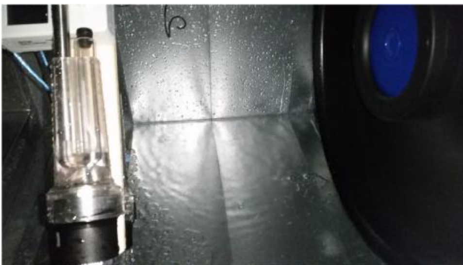
Obr. 3.31 Hromadění vody za zvlhčovačem
