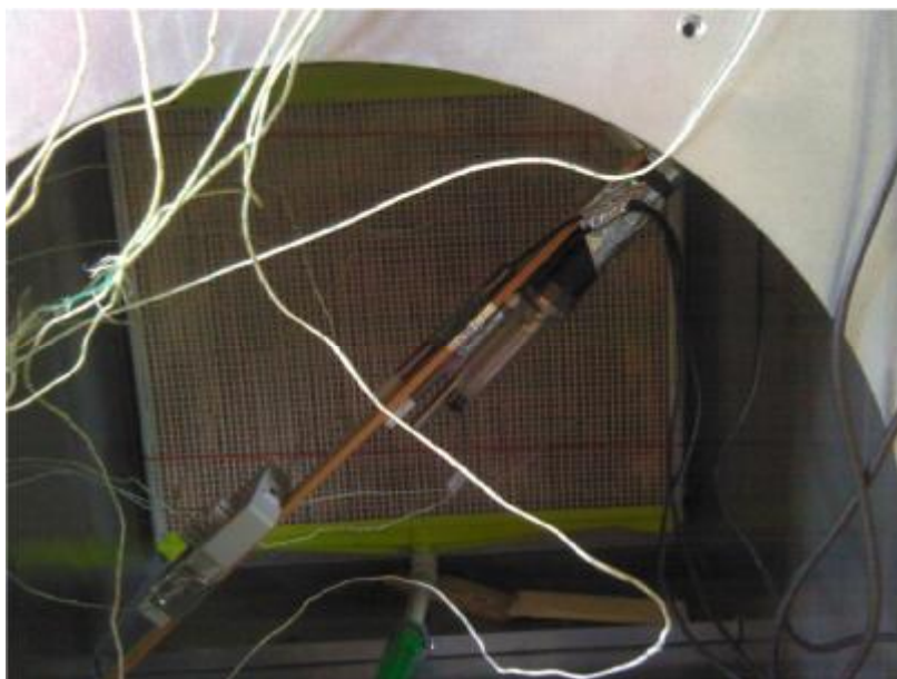
Obr. 3.30 Umístění měřících čidel do dráhy
