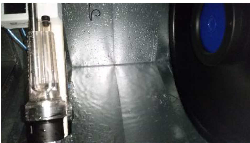
Obr. 3.31 Hromadění vody za zvlhčovačem
