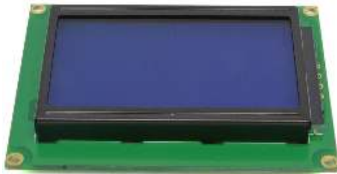
Obr. 3.4: Vybraný LCD displej s řadičem ST7920
