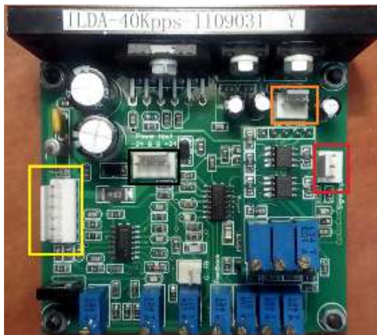
Obr. 6.5: Podpůrná deska k galvo motorům s vyznačenými piny pro připojení
