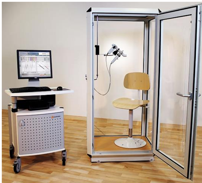
Obr. 12 Spirometr MasterScreen Body Jaeger (převzato z: [39])
