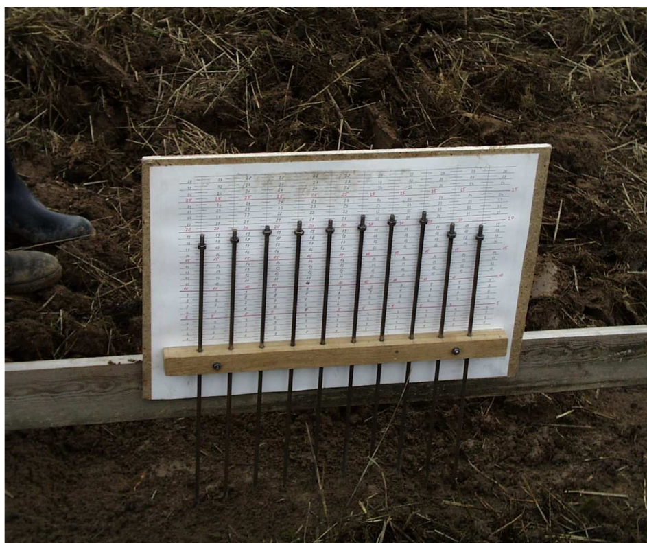
Obrázek 37: Zařízení pro měření profilu povrchu pozemku.
