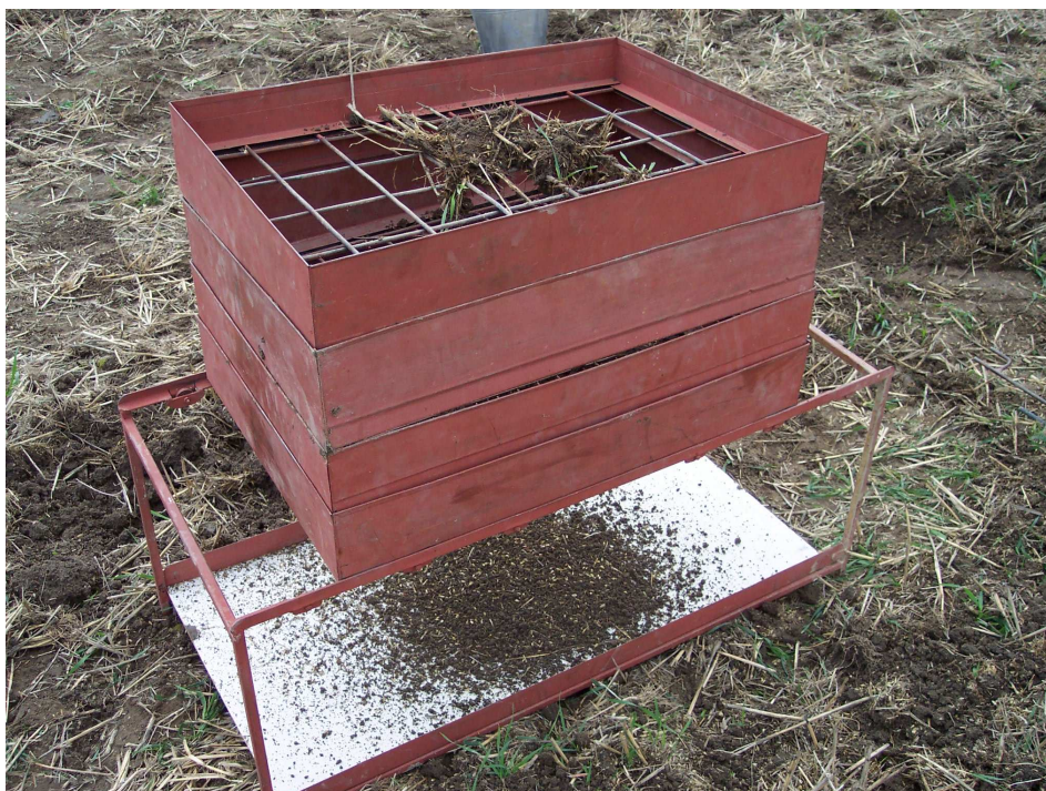
Obrázek 36: Zařízení pro rozbor hrudovitosti.
