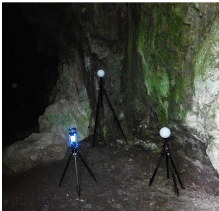
Obr. 7. Proces skenování. Na obrázku skener a referenční koule. (foto: autor)
