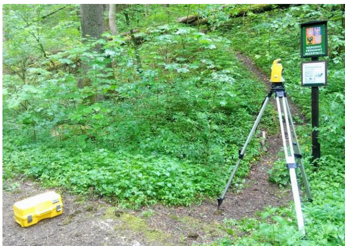
Obr. 5. Tvorba přípojovacího polygonu za pomoci totální stanice. (foto: autor)
