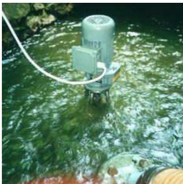
DVE 120 s převodovkou a generátorem 3 x 400 [V]
