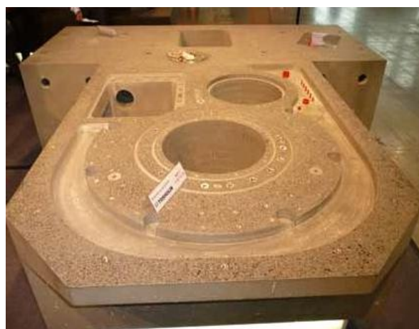
Obrázek 9: Lože karuselu z HPC betonu firmy Toshulin [1]
