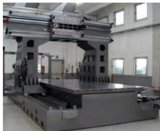
Obrázek 6: Svařovaný rám portálového stroje firmy Benazzato S. r. l. [21]
