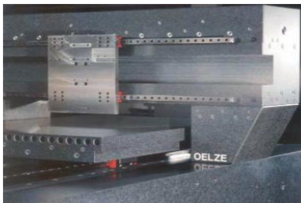
Obrázek 21: Nosná struktura portálového vertikálního centra pro mikrofrézování [23]
