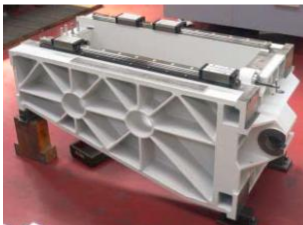
Obrázek 5: Odlitek stojanu horizontálního frézovacího centra z tvárné litiny [23]
