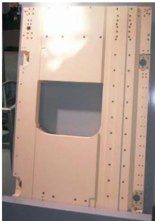
Obrázek 13: Keramická deska křížového stolu drátového řezacího stroje [23]
