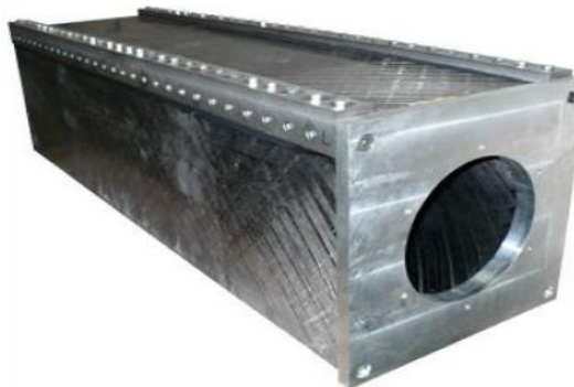
Obrázek 12: Vřeteník z uhlíkového vlákna [29]
