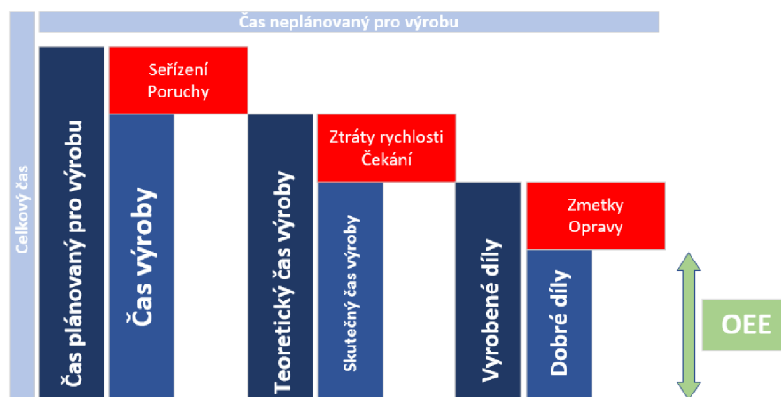
Obrázek č. 7: Grafické vyjádření OEE (Zdroj: 11)
