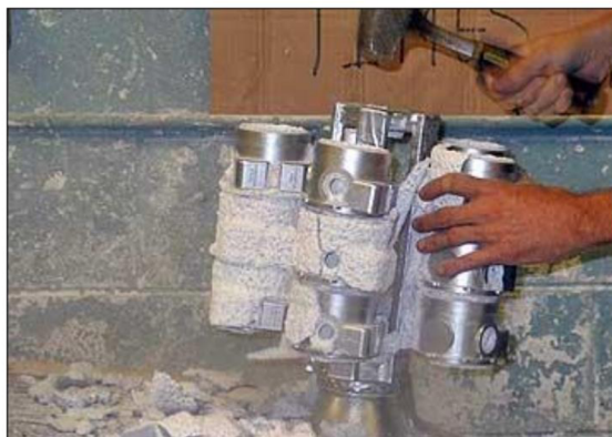
Obrázek 9- Ruční odstranění keramiky (OSTRATICKÝ, 2015)
