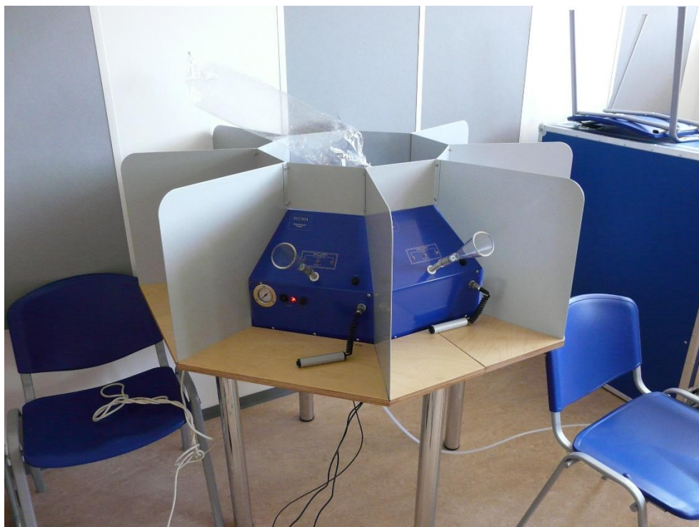
Obrázek 26 – Olfaktometr s osmy místy pro hodnotící komisy (zdroj: Autor)
