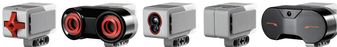
Obrázek 8: Nejběžnější senzory. Zleva: dotykový, ultrazvukový, barevný/světelný, gyroskopický, infračervený.
