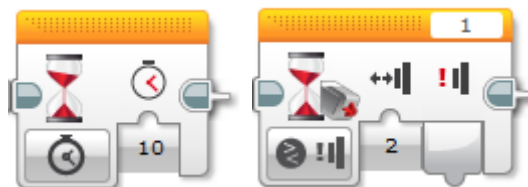
Obrázek 14: Příkazy k čekání po určitý čas (vlevo) či na zadanou hodnotu senzoru (vpravo).
