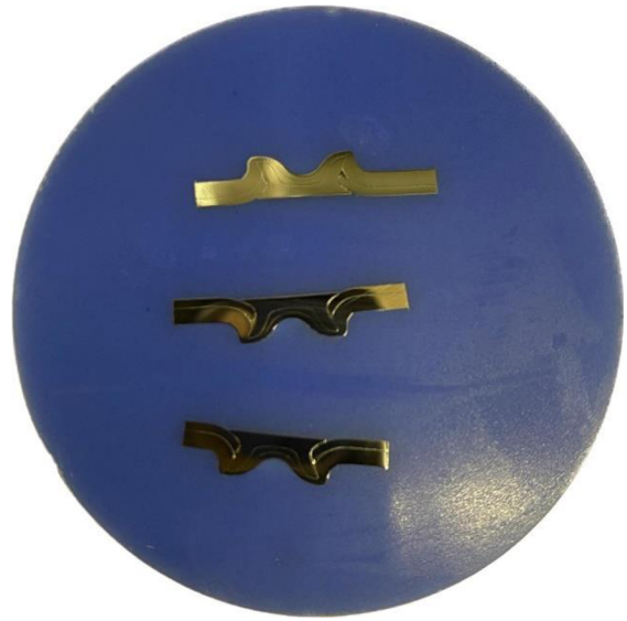
Obr. 45: Metalografický výbrus po vyleštění [zdroj vlastní]
