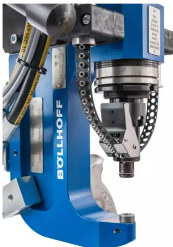
Obr. 19: Lis pro samoděrovací nýtování s pásovým zásobníkem nýtů [28]
