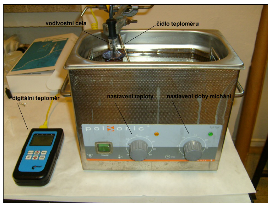
Obr. 3.3: Měření kapalných elektrolytů ve vodní lázni pomocí UZV
