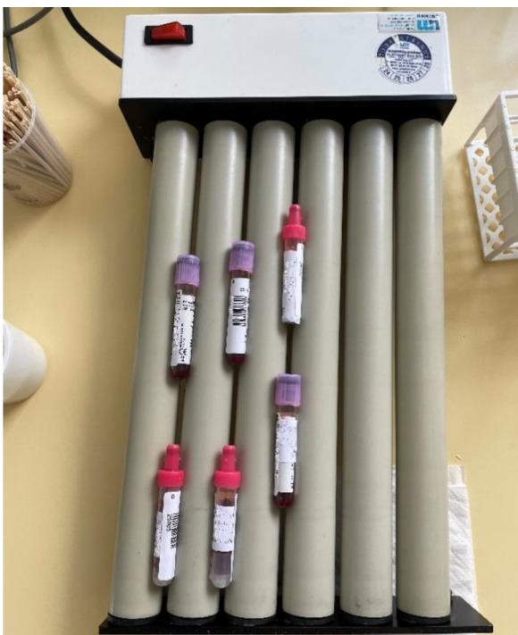
Příloha 2: Rotační míchačka na zkumavky (Zdroj: Vlastní)
