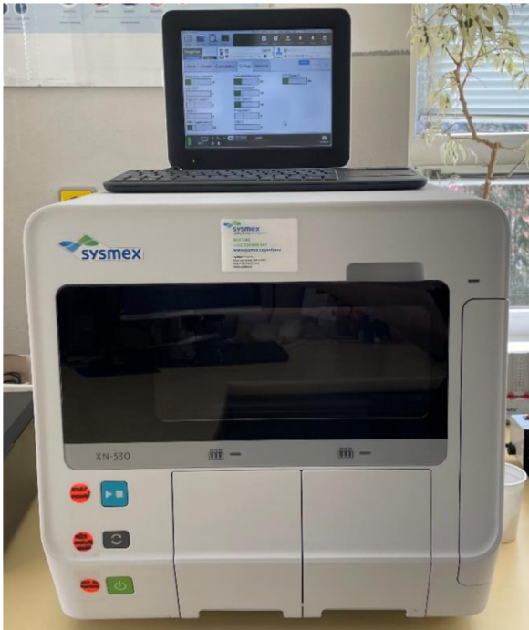
Příloha 1: Automatický hematologický analyzátor XN-530 (Zdroj: Vlastní)
