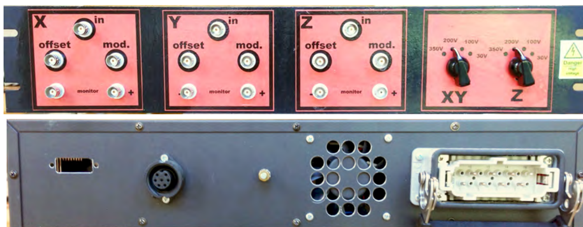
Obrázek 4.3: Fotografie VN zesilovače vlastní výroby. Čelní panel (nahore) se vstupy, monitorovacími výstupy a přepínači zesílení. Zadní panel (dole) s vysokonapěťovými konektory (vstupní a výstupní).
