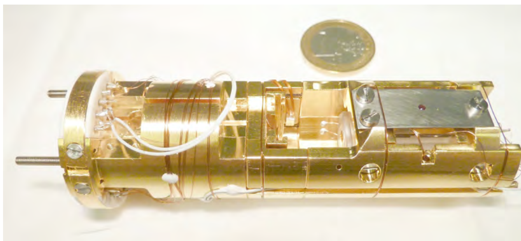
Obrázek 5.1: Fotografie těla STM mikroskopu používaného na univerzitě v Hamburku.
