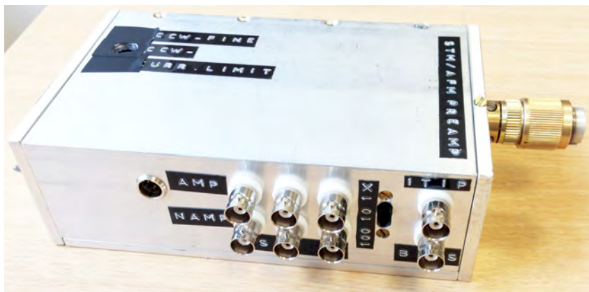
Obrázek 4.8: Fotografie kombinovaného STM/AFM předzesilovače vlastní výroby, je určen pro měření s mikroskopem UHV SPM vyvinutém na VUT.
