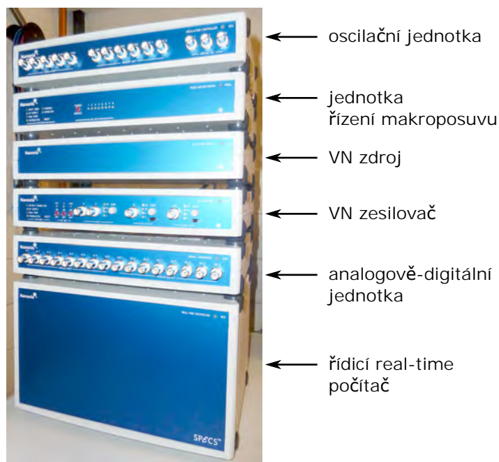
Obrázek 5.8: Fotografie řídicího systému firmy Nanonis, používaný pro měření s mikroskopem qPlus na UHH.
