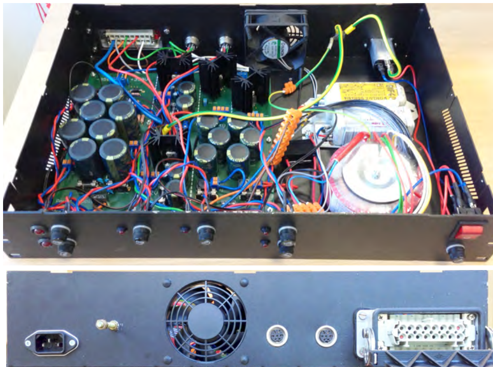
Obrázek 4.6: Fotografie napěťového zdroje vlastní výroby. Otevřená jednotka s čelním panelem (nahore), na kterém jsou umístěny kontrolní LED a tavné pojistky jednotlivých napěťových výstupů a hlavní vypínač. Zadní panel (dole) s vysokonapěťovým konektorem pro napájení VN zesilovače, dalšími výstupy pro napájení analogových obvodů a vstupem napájecího síťového kabelu.
