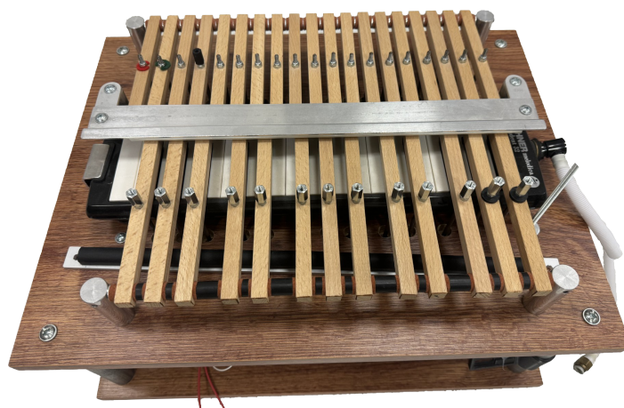
Obr. 3.2: Fúkacia harmonika osadená na prípravku so solenoidmi
