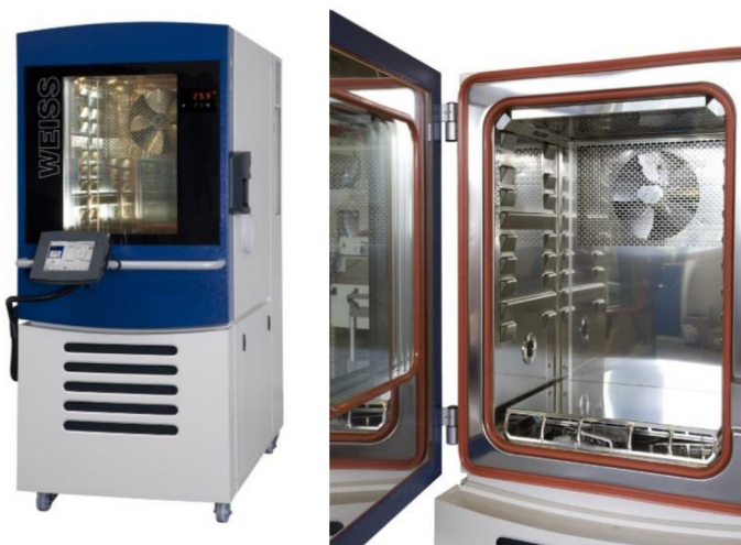
Obr. 7 Klimatická komora Weiss WK3-180/70 [24].
