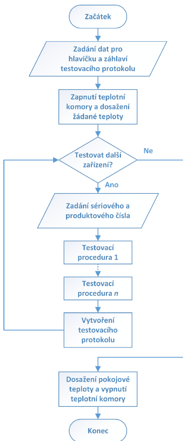
Obr. 31 Algoritmus znázorňující vykonávání testovací sekvence.
