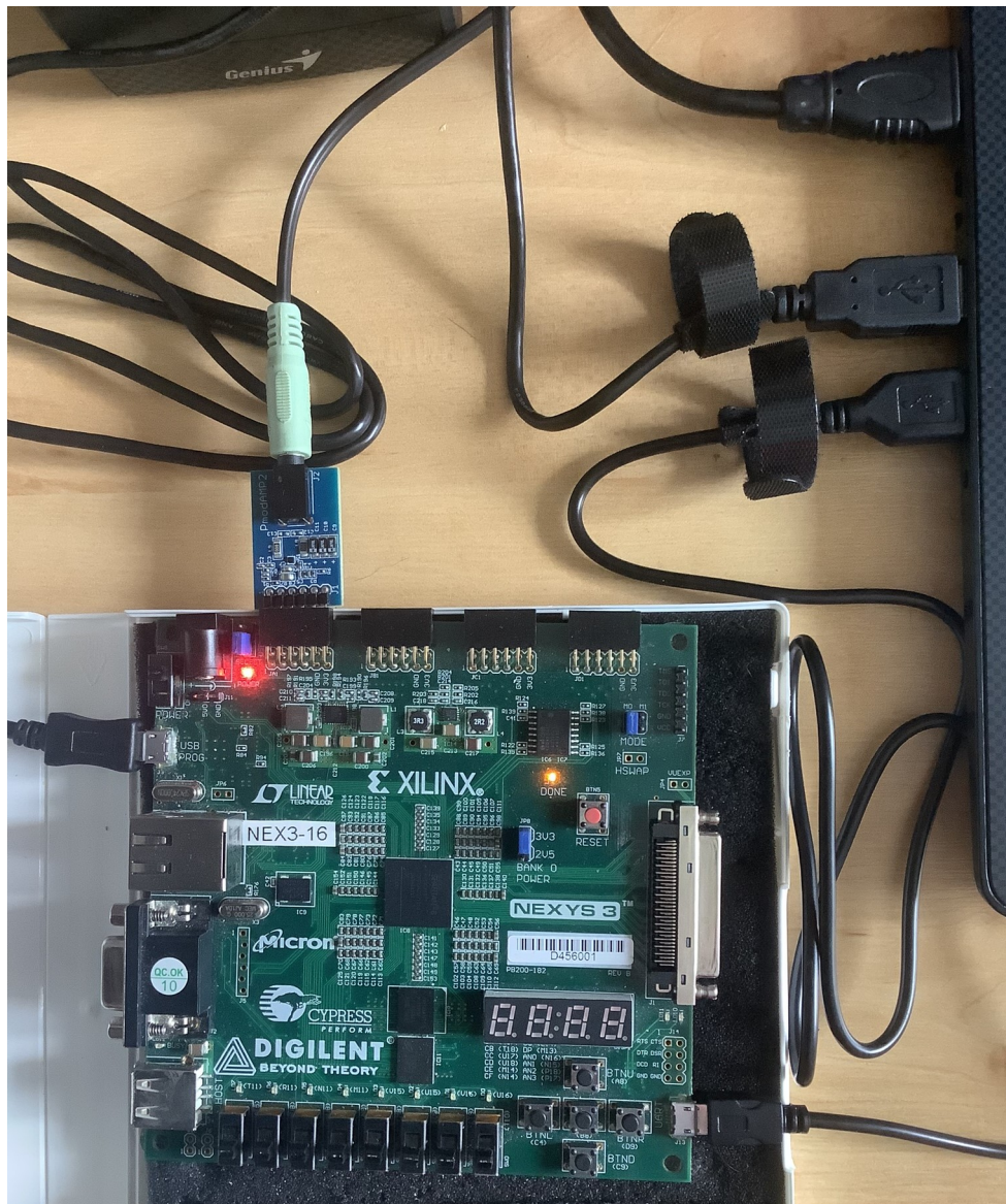
Obr. 6.2: Fotografie kompletního zapojení vývojové desky pro přehrávání zvukových dat, jehož návrh je uveden v kapitole 4
