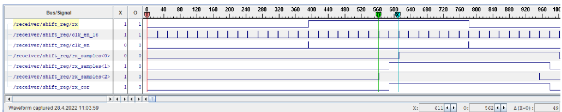
Obr. 5.8: Průběh analýzy vzorkování příchozích bitů přijímačem
