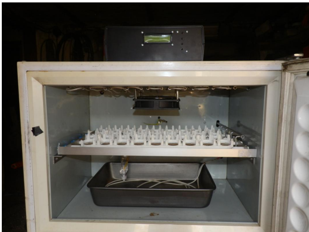
Obr. 23: Řídicí jednotka připojená k líhni
