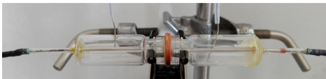
Obr. 8 – Dvoukomorová měrná cela složená ze dvou vialek. Uvnitř každé vialky se nachází kapilára s referentní argentchloridovou elektrodou
