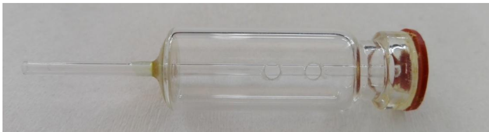
Obr. 7 - Upravená vialka tvořící jednu z komor měrné cely
