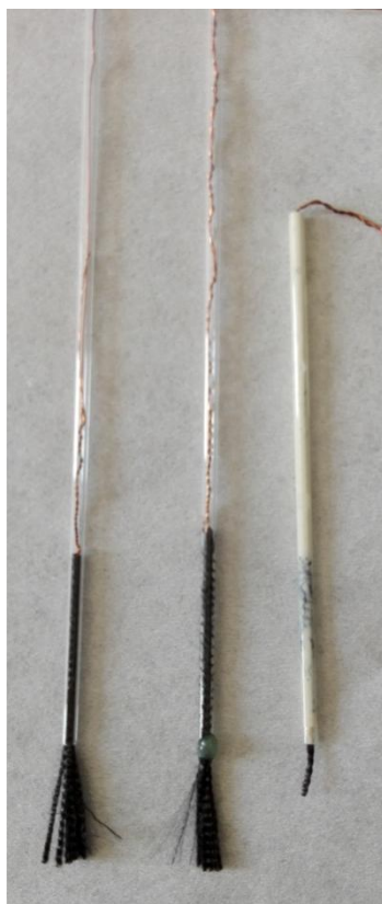
Obr. 6 - Elektrody z uhlíkových vláken. Zleva doprava – elektroda nelepená, elektroda utěsněná epoxidem, tmelená elektroda
