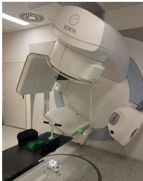
Obrázek 2: Hlavice lineárního urychlovače Elekta (zdroj: autor)
