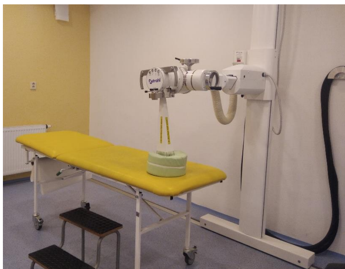
Obrázek 1: Rentgenový ozařovač s nasazeným tubusem (zdroj: autor)
